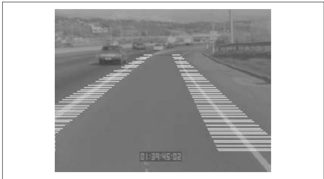
Figura 24.23 Imagen de una carretera tomada desde una cámara en el interior de un coche. Las barras blancas horizontales indican las ventanas de búsqueda en las que el controlador busca los marcadores del carril. La baja calidad de la imagen no es atípica en vídeos en escala de grises de baja resolución.
