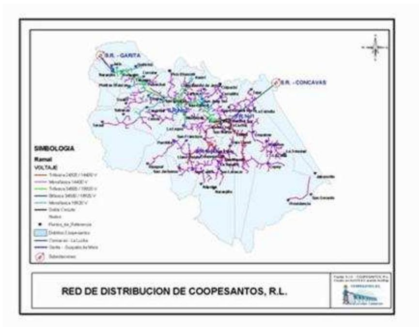
**Figura Nº 2 Red de distribución de energía eléctrica de COOPESANTOS R.L.**
