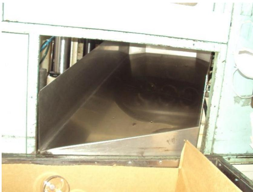
**Figura 9: Ejemplo de Tobogán por donde se deslizan los envases**
