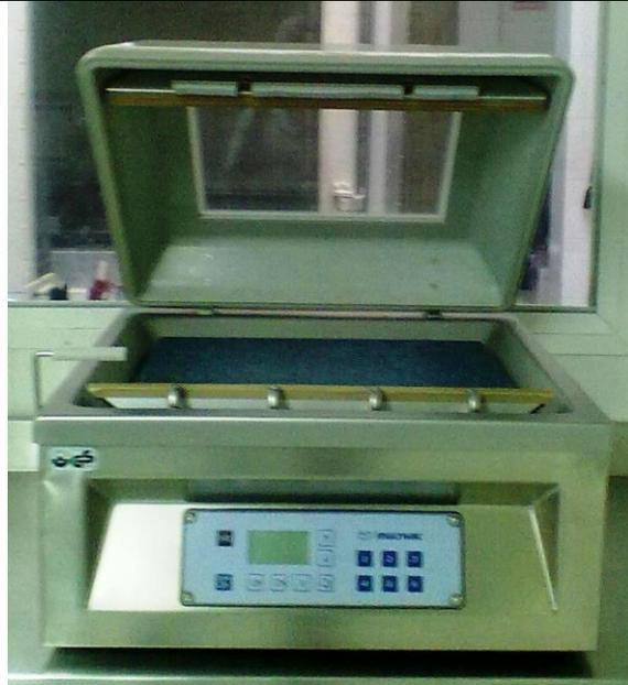
**ESPECIFICACIONES****Longitud de sellado: 465 mm****Peso: 70 kg****Presión mínima: 0,7 bar****Presión máxima: 2,5 bar****Marca: Multivac****Modelo: C 200****Voltaje: 110 V****Frecuencia: 60 Hz****1,3 kw****INFORMACION GENERAL**
