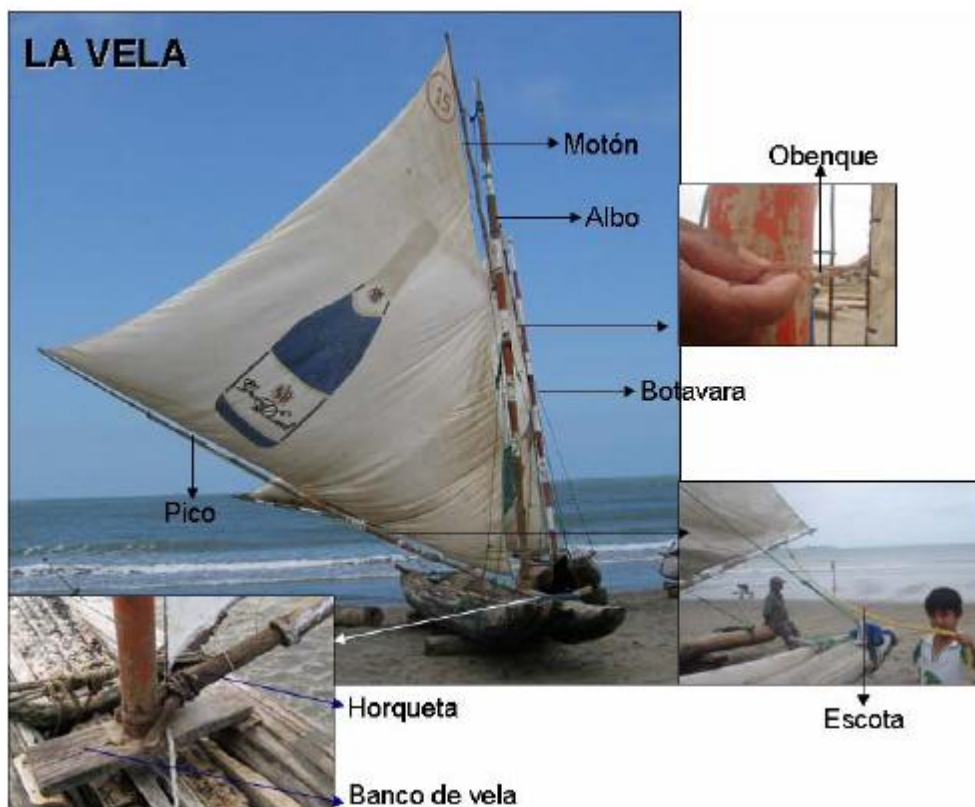
Figura 10: Componentes de la vela de una balsa Fuente: Pinos Mariela
