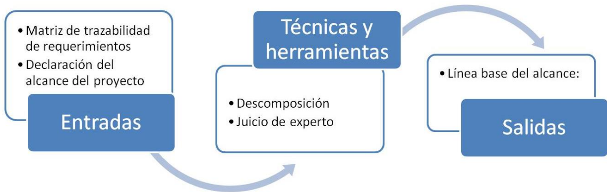
Figura 13: entradas, técnicas y herramientas, y salidas del proceso de crear la Estructura de Desglose de Trabajo (EDT).
