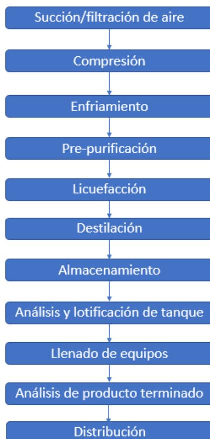
**Figura 1.** Diagrama de flujo del proceso de producción de nitrógeno líquido
