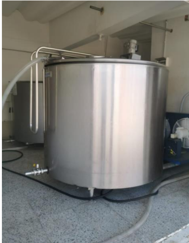
Ilustración 5. Tanques de almacenamiento centro de Acopio (APROLECHO)
