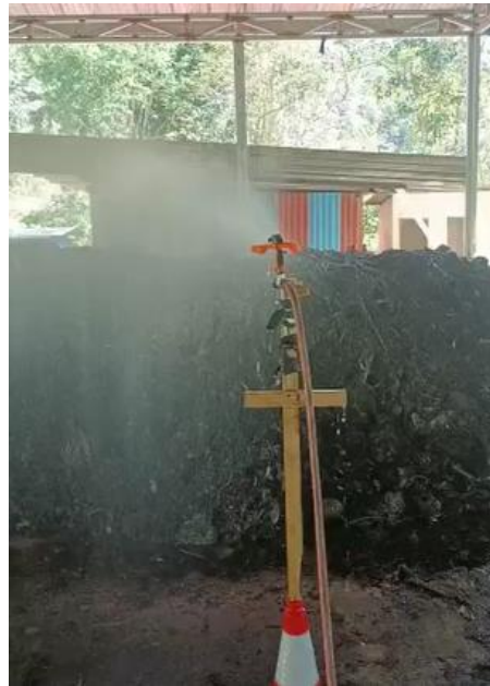
Figura 25. Colocación de aspersores para humedecimiento del compost.
