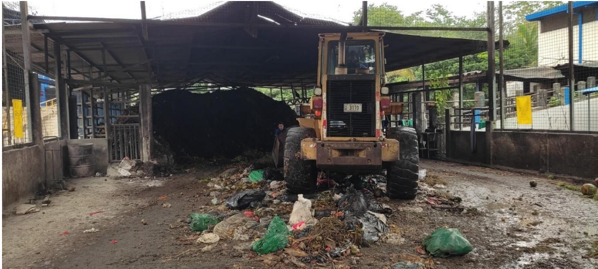
Figura 13. Maquinaria apoyando la apertura del residuo sólido orgánico.
