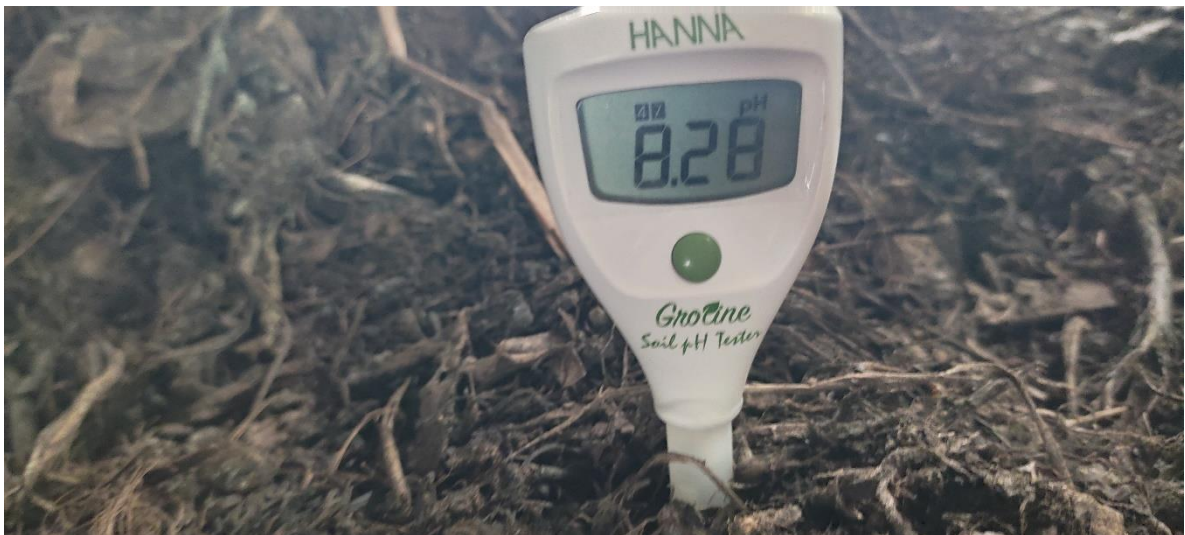
Figura 31. Equipo para la medición del potencial de hidrógeno.
