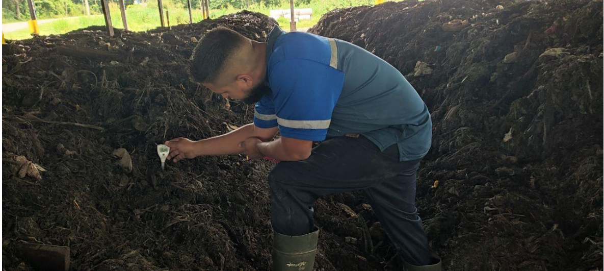
Figura 30. Personal municipal realizando la medición del potencial de hidrógeno (pH) en una de las pilas de compost.
