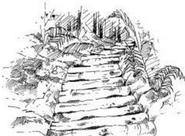
*Figura N° 7. Superficie de piedra o “riprap” para pendientes moderadas.*
