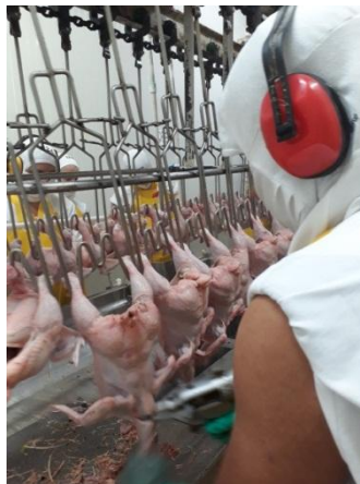
Figura 17. Descolgado de cabezas y corte de cuello
