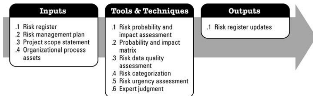
Figura 32. Realizar el Análisis Cualitativo de Riesgos: Entradas, Herramientas y Técnicas, y Salidas (López, s.f.).
