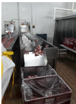
Figura 23. Enfriamiento de hígado, corazón y mollejas
