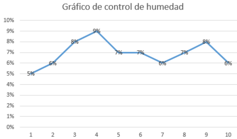
Figura 15 Diagrama de control para el % de humedad
