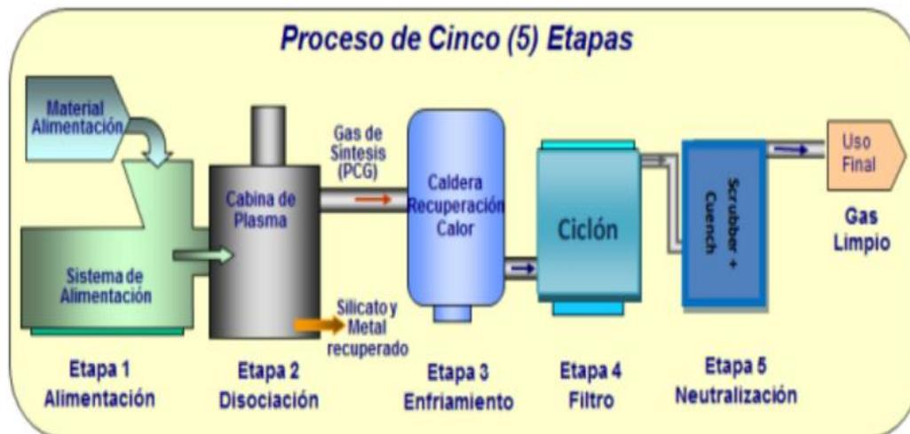
*Nota:* Se muestra las etapas del proceso de gasificación por plasma. (Montijano, 2022).
