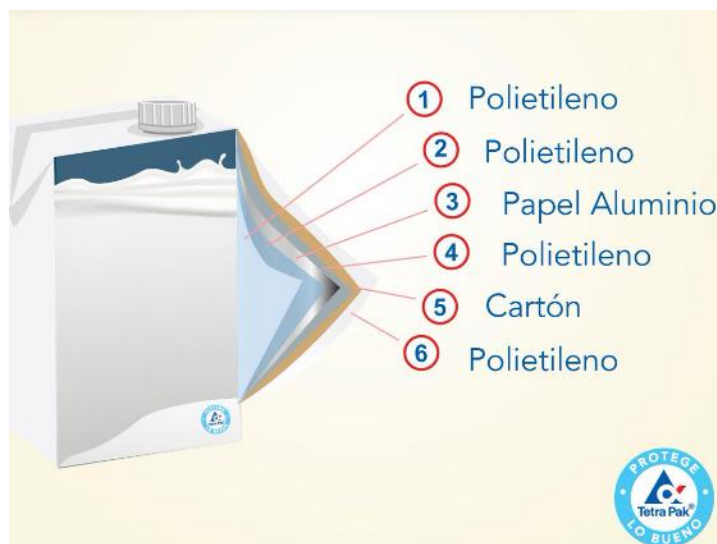
Figura 2. Estructura de los envases Tetra Pak (Fuente: adaptada de Tetrapak 2022).
