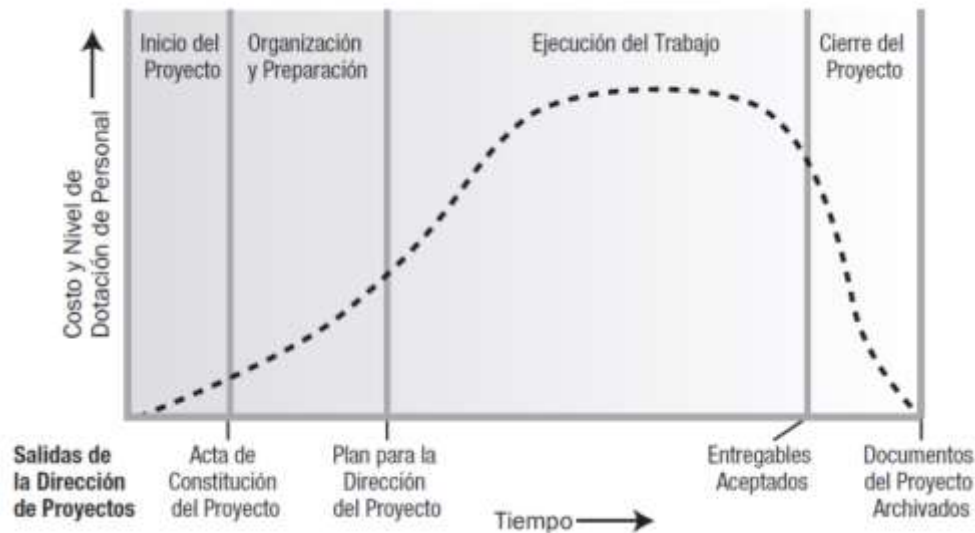
Figura 3. Niveles típicos de costo y dotación de personal en una estructura genérica de ciclo de vida de proyecto (fuente: Guía del PMBOK 5° edición, 2013 p.39)
