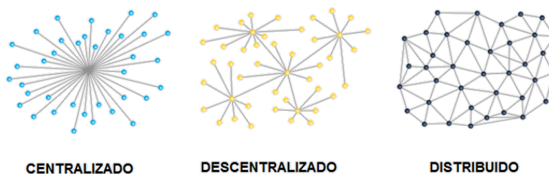
Figura 2 Representación gráfica de los sistemas centralizados, descentralizados y distribuidos.
