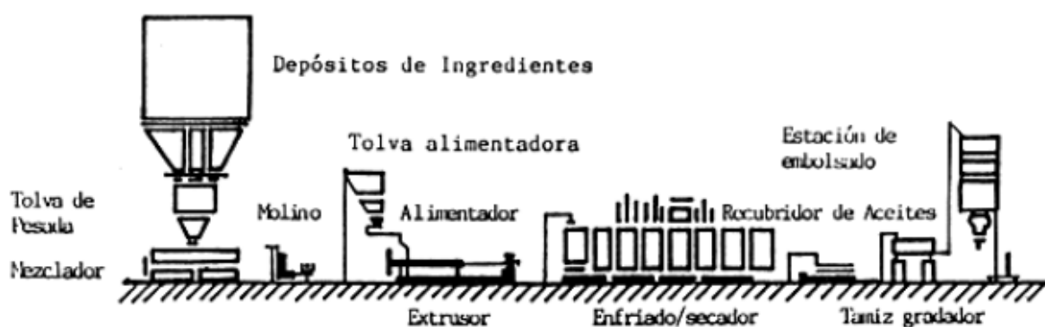
Figura 10. Diagrama del proceso de la elaboración de piensos mediante extrusión. (FAO, 2003)
