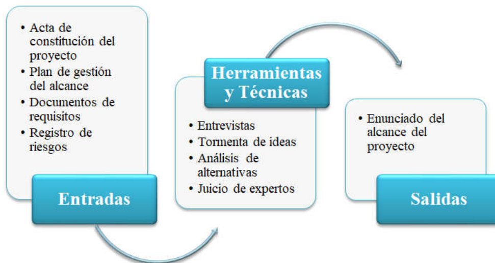
Figura 15. Entradas, Herramientas, Técnicas y Salidas de Definir el Alcance. Fuente: (Elaboración propia, 2020)
