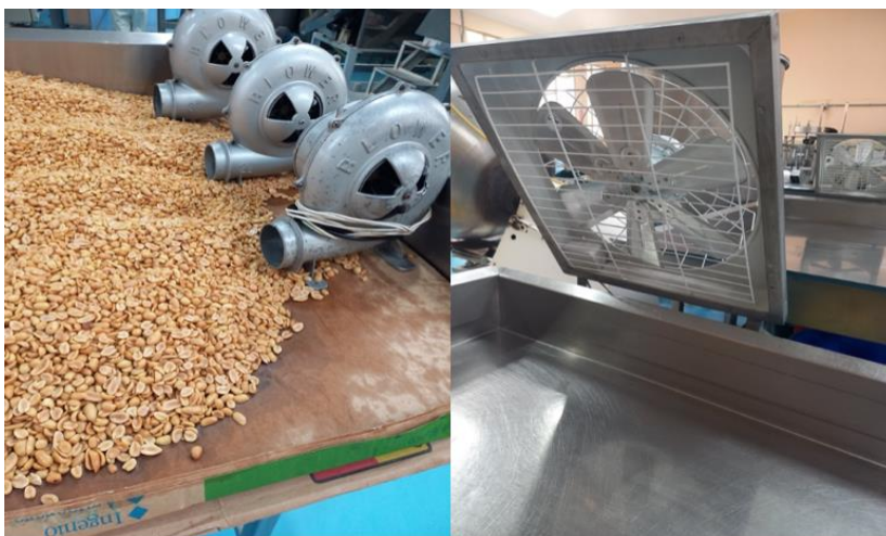
Ilustración 6. En la izquierda se observan los sopladores antiguos no adecuados y en la derecha, los nuevos ventiladores. Fuente: Autor.
