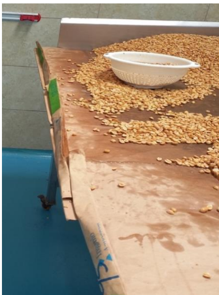
Ilustración 8. Antigo método de secado de exceso de aceite con papel Kraft. Fuente: Autor.
