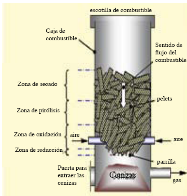
Figura 7 Diagrama de gasificador tipo descendente updraft
