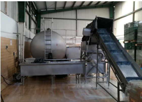
Figura 35. Ubicación actual del triturador, el cual genera mucho derrame de líquidos en el área.
