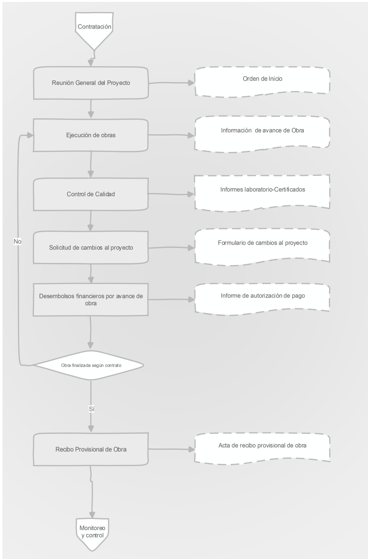
Figura 37. Flujograma de fase construcción. Fuente: (Elaboración propia)
